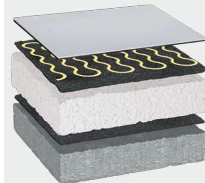
Bei vielen Altaufbauten – auch bei Bitumen und auf weichmacherhaltigen Abdichtungen – kann die spezielle PVC-P Sanierungsbahn BauderTHERMOFOL U 15 V eingesetzt werden. Diese Bahn ist unterseitig vlieskaschiert. Sie wird in der Fläche mit PU-Kleber verklebt und an den Nähten heißluftverschweißt. Kopf- und Querstöße werden stumpf gestoßen und mit 20 cm breiten unkaschierten Streifen BauderTHERMOFOL überschweißt.
